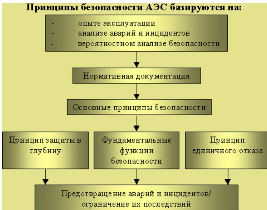
**Рисунок 3 – Принципы безопасности АЭС**
